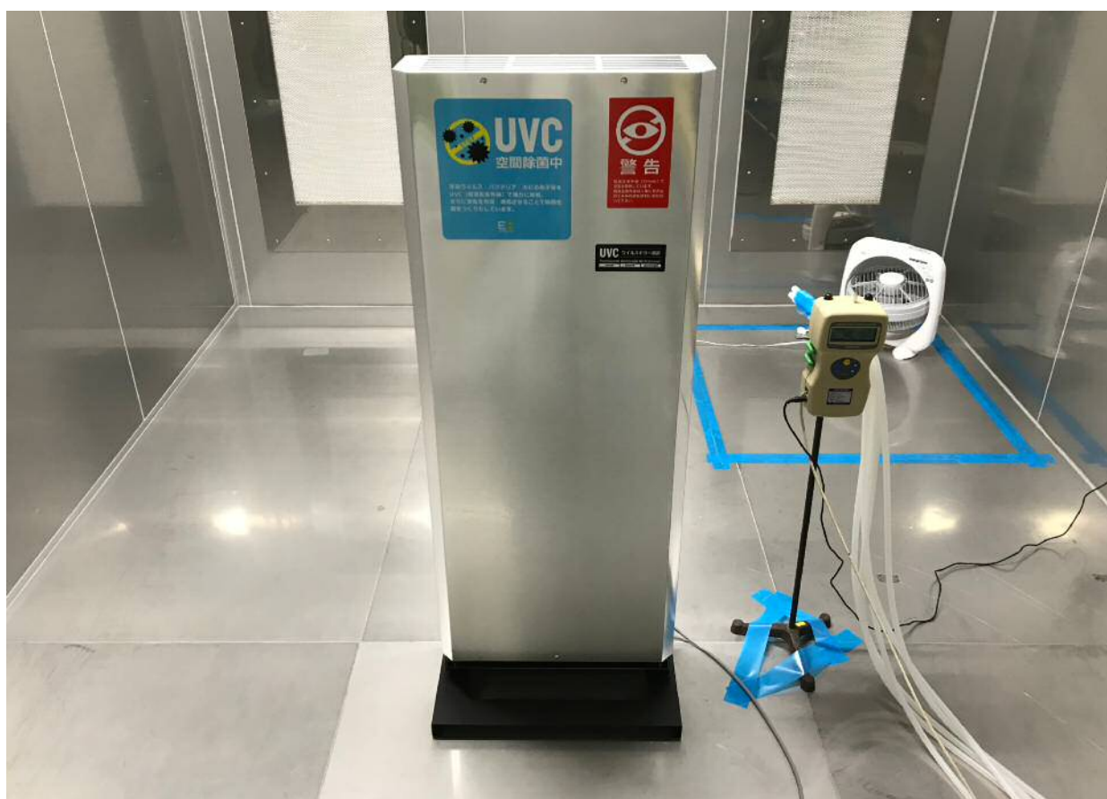
別紙図 b. 試験品試験時の 25 m 3 試験チャンバーの様子
